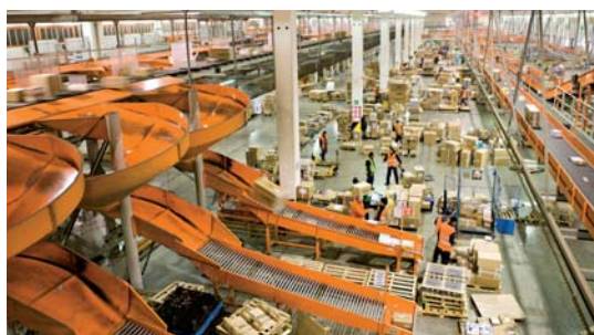
Fives Cinetic collabora con il corriere espresso TNT dal 1998: la più recente soluzione installata presso Milano Mega è stata attivata nel 2008 e si basa su un cross belt sorter SBIR Maxi Duty Dynamic di 67 m di lunghezza, con un'unica linea di induzione inclinata di 15°, una portata massima di 4.000 pezzi all'ora e 16 destinazioni
