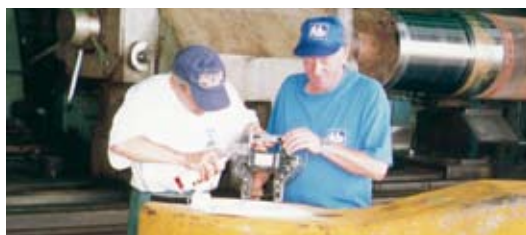
Magnétoscopie avant pré-usinage et soudage
