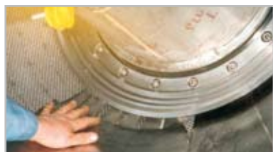
Pose des tamis en moins d'une heure (modèles FC 1250e et FC 1550)
