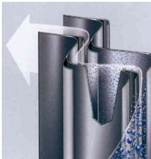
Fig. 5: Zigzag separator scheme
