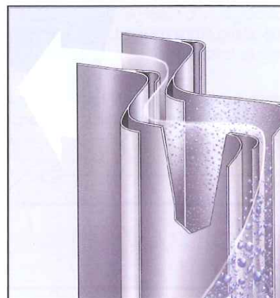
Figure 5. Schéma de principe de fonctionnement du séparateur zigzag
